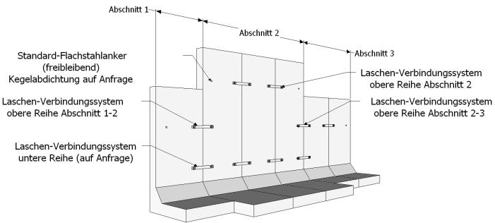
Bei Höhenversprüngen in den einzelnen Abschnitten, sind die Anreihungen der Abschnitte bekanntzugeben! Ansonsten wird die Verbindung zwischen Abschnitt 1-2 bzw. 2-3 nicht möglich sein!
